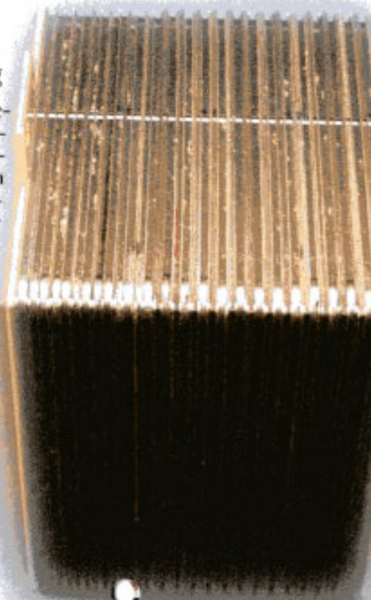
Gestapelte Kraft: Das Herz jeder Brennstoffzelle ist der Stack (Zellstapel).
