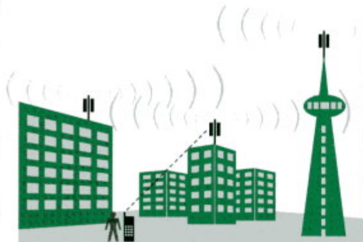
Bei der GSM-Technik ist ein Handy immer mit einer Basisstation verbunden und wechselt beim Übergang von Zelle zu Zelle – dem Handover – zu einer neuen Station.
