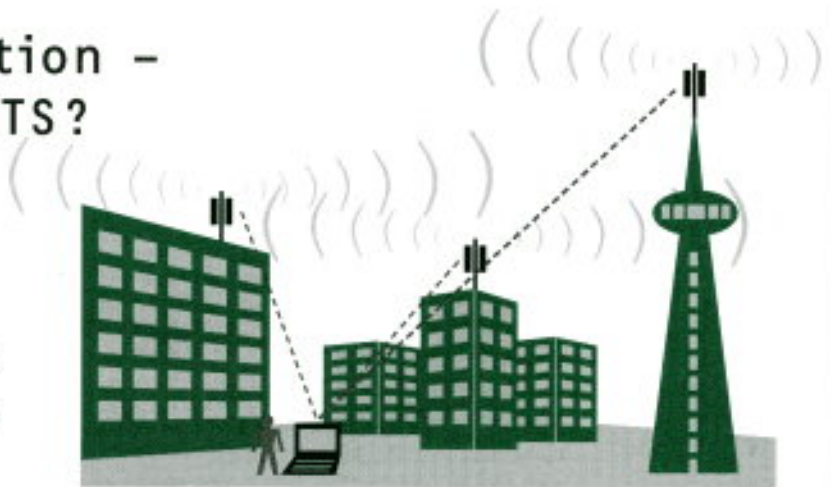
UMTS-Geräte können mit mehreren Basisstationen kommunizieren. Je nach Bedarf entscheidet das Gerät, welche Zelle am besten für die Kommunikation geeignet ist und stellt die Verbindung her.
