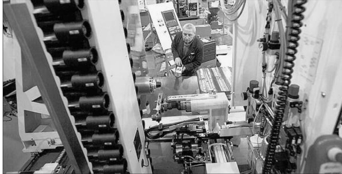
Montage eines Starrag-Heckert-Bearbeitungszentrum für die Automobilindustrie.
