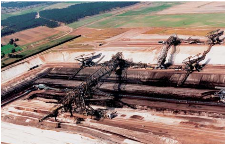
Tagebau Jämschwalde: Abraumförderbrücke F60 mit Eimerkettenbaggern
